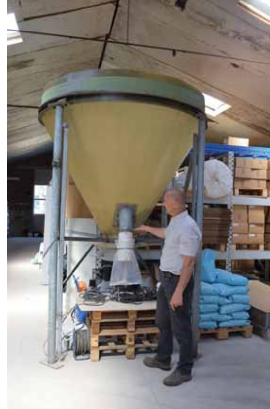
Hier bij een deel van een voersilo in de loods, waar op een eenvoudige wijze het nieuwe voegmateriaal zal worden verpakt.
